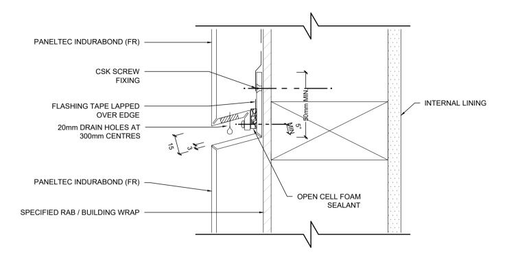
23. HORIZONTAL OPEN JOINT / INTERSTORY JOINT / HORIZONTAL EXPANSION JOINT SCALE 1:2 @ A4
