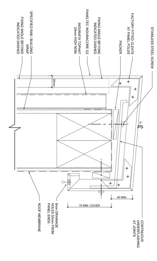
17. PARAPET SCALE 1:2 @ A4
